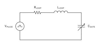
$$\zeta = \frac{R_{LOOP}}{2} \sqrt{\frac{C_{GATE}}{L_{LOOP}}} \ge 1$$
